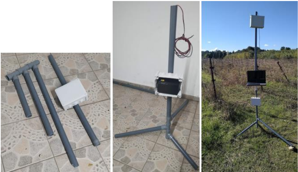
Εικόνα 11 - Κατασκευή και δοκιμή σταθμού μετρήσεων (LoRa Node)
