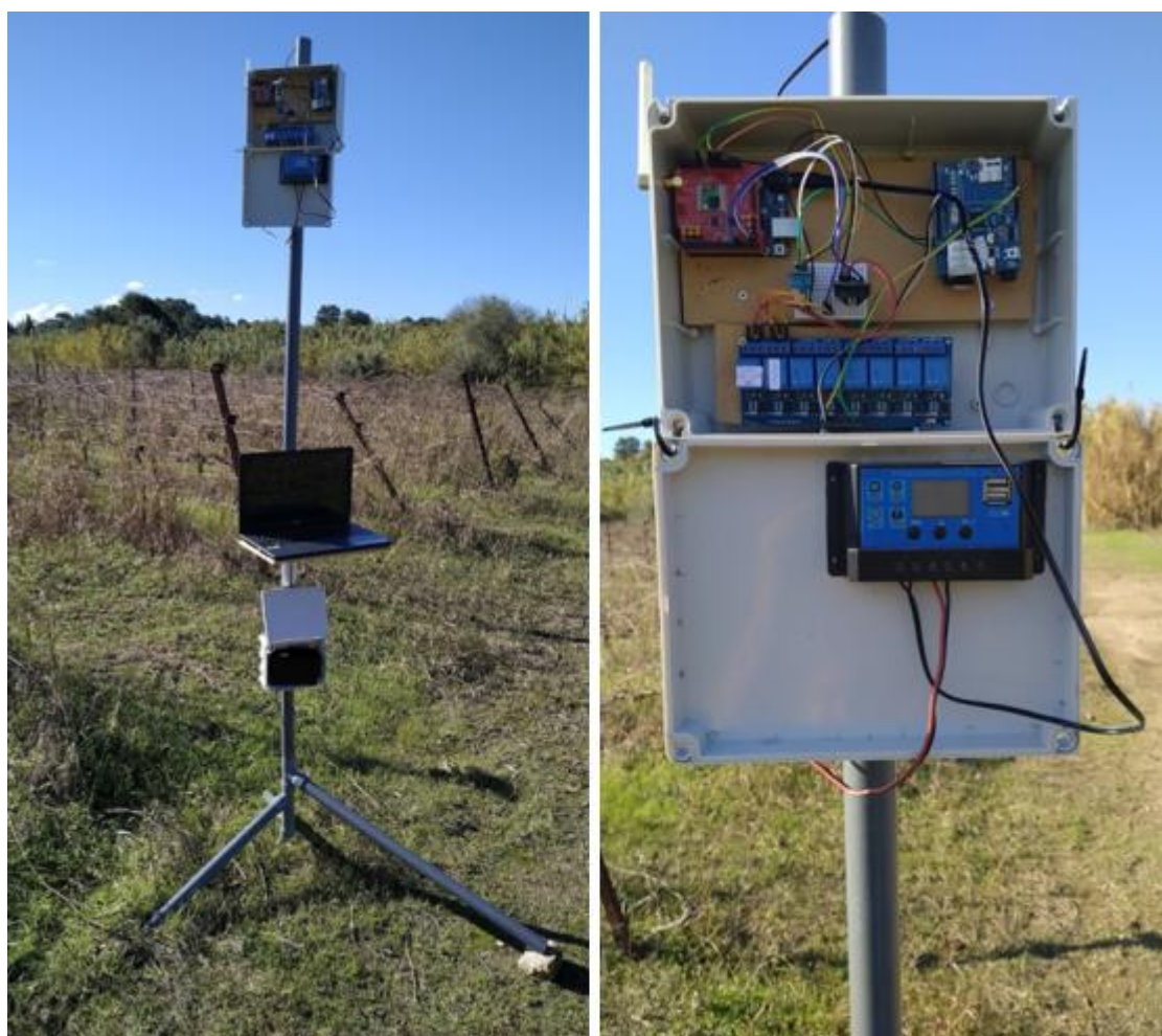
Εικόνα 13 - Σταθερός σταθμός μετρήσεων (LoRa Node).
