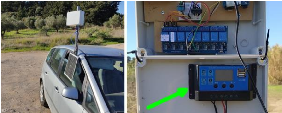
Εικόνα 15 - Ελεγκτής φόρτισης μπαταρίας LoRa Node από φωτοβολταϊκό πάνελ.
