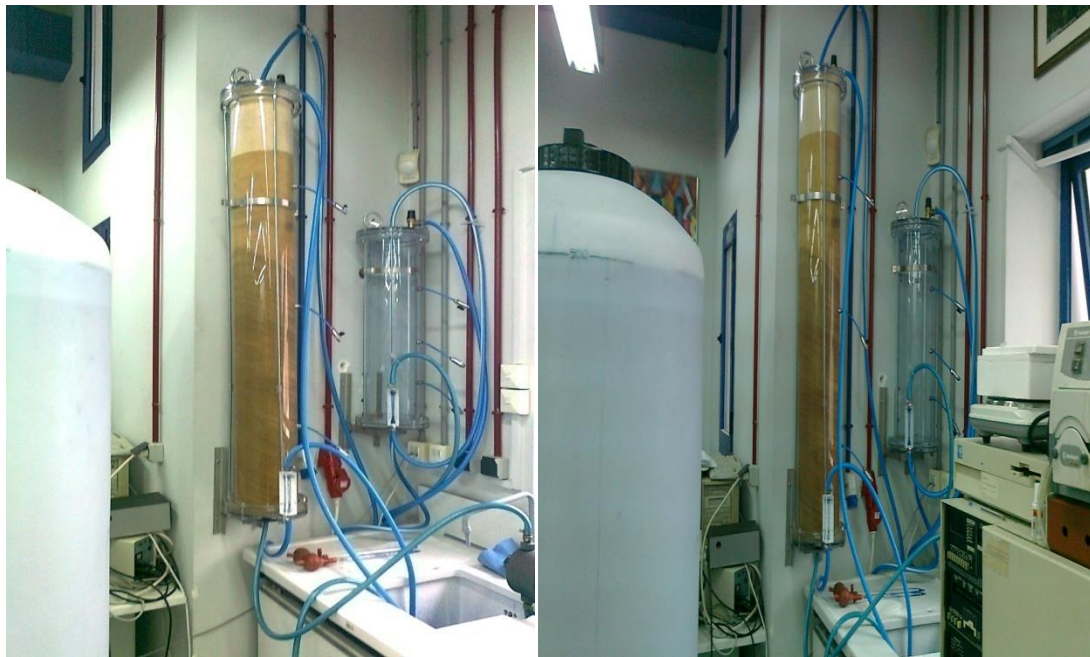
Εικόνα 26: Στήλη προσρόφησης (μήκους 150cm) κυανού του μεθυλενίου κατά την διαδικασία
