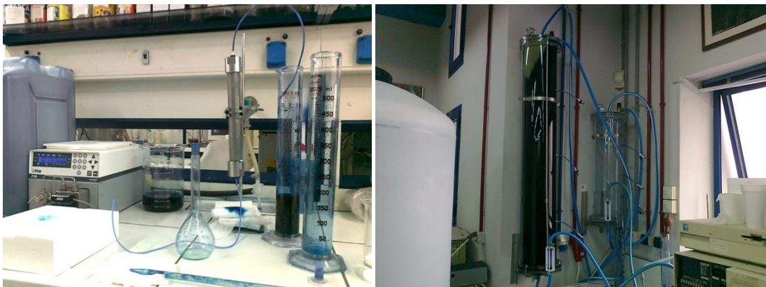
Εικόνα 17: Στήλη προσρόφησης (μήκους 25cm και 150cm) κυανού του μεθυλενίου κατά την διαδικασία σε μερικό κορεσμό
