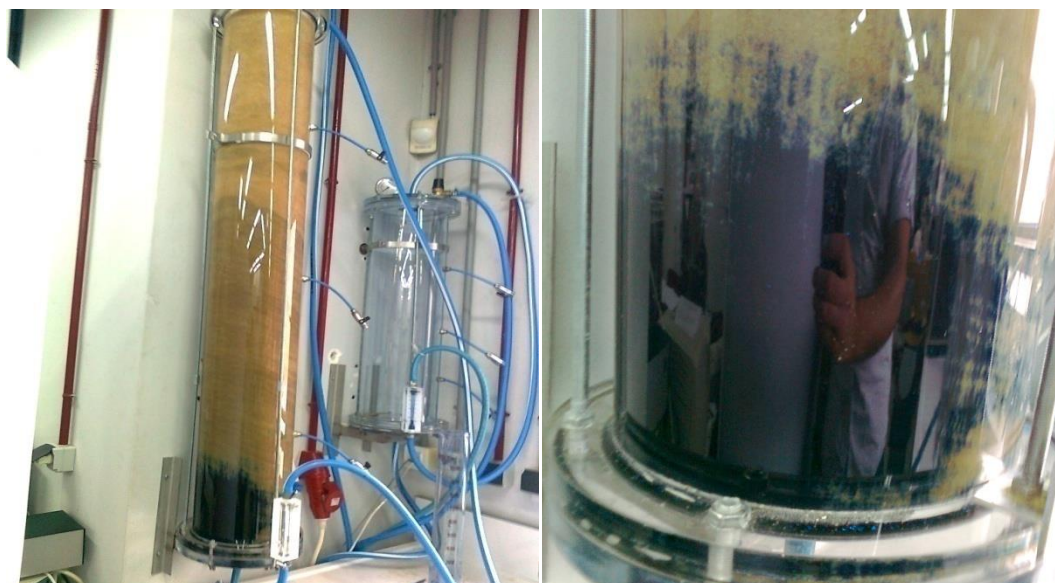
Εικόνα 31: Στήλη προσρόφησης (μήκους 150cm) κυανού του μεθυλενίου κατά την διαδικασία σε μερικό κορεσμό
