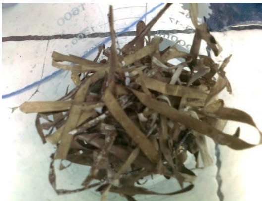
Εικόνα 93: Στήλη προσρόφησης μήκους 15cm με πληρωτικό υλικό απροκατέργαστα ποσειδώνια (φύκια)
