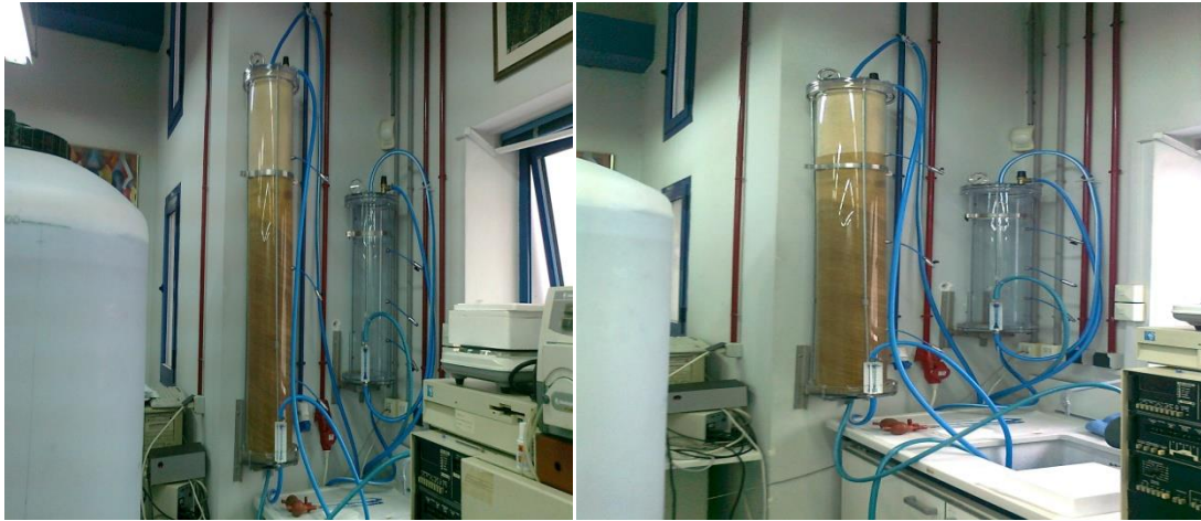
Εικόνα 24: Στήλη προσρόφησης (μήκους 150cm) κυανού του μεθυλενίου κατά την διαδικασία
