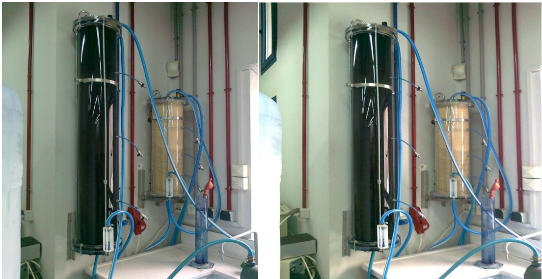
Εικόνα 45: Στήλη προσρόφησης (μήκους 150cm) κυανού του μεθυλενίου κατά την διαδικασία σε πλήρη κορεσμό
