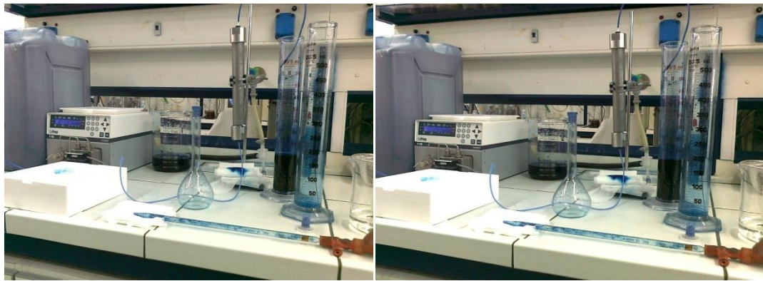
Εικόνα 98: Στήλες προσρόφησης μήκους 15cm και 25cm αντίστοιχα με πληρωτικό υλικό απροκατέργαστα ποσειδώνια (φύκια)
