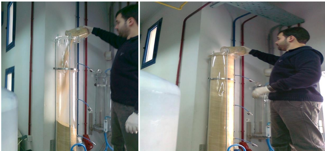
Εικόνα 2: Πλήρωση στήλης μήκους 150cm με απροκατέργαστο πριονίδι ερυθρελάτης (spruce)
