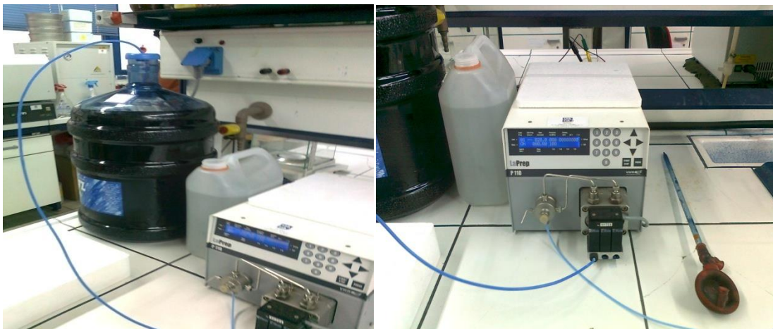
Εικόνα 47: Αντλία κενού τύπου La Prep και διάλυμα κυανού του μεθυλενίου (Methylene Blue)
