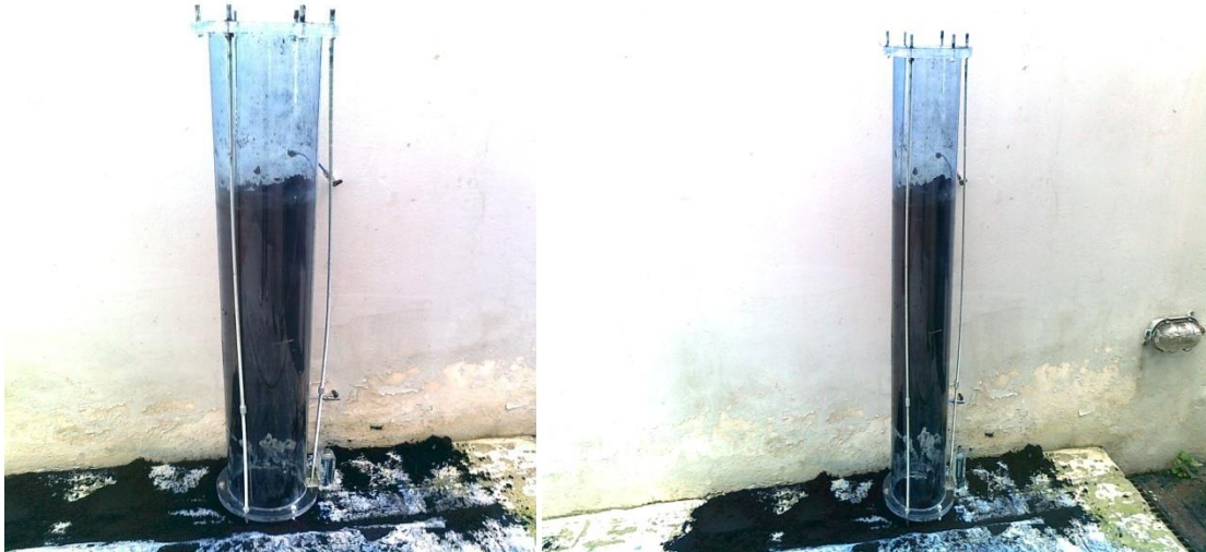
Εικόνα 62: Στήλη προσρόφησης μήκους 150cm σε καθαρισμό
