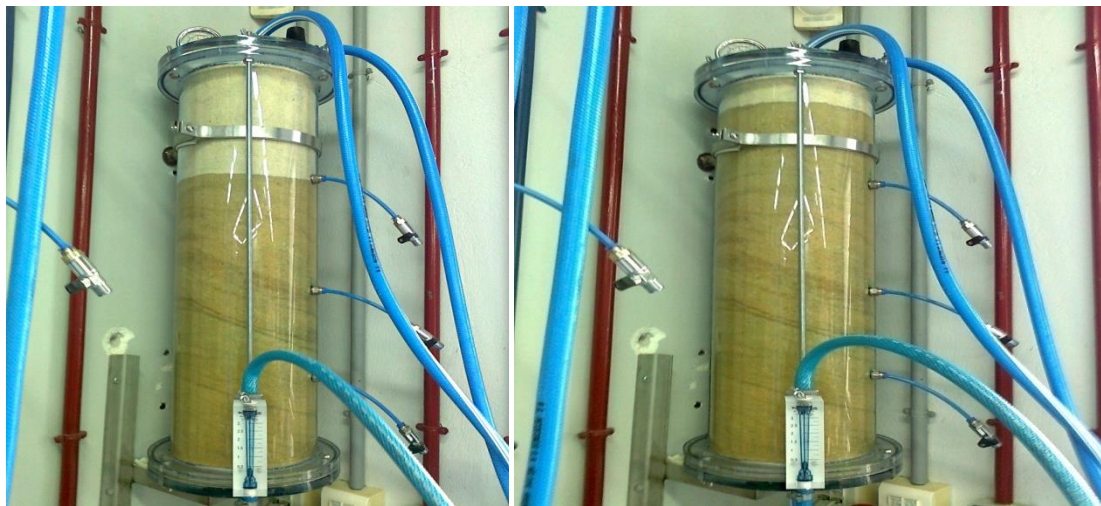
Εικόνα 11: Στήλη προσρόφησης (μήκους 75cm) κυανού του μεθυλενίου κατά την διαδικασία
