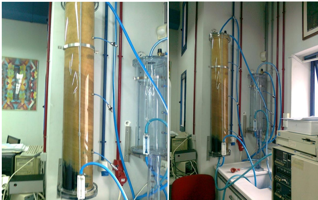
Εικόνα 33: Στήλη προσρόφησης (μήκους 150cm) κυανού του μεθυλενίου κατά την διαδικασία σε μερικό κορεσμό
