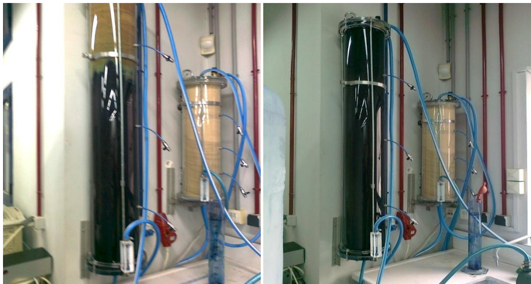
Εικόνα 41: Στήλη προσρόφησης (μήκους 150cm) κυανού του μεθυλενίου κατά την διαδικασία σε μερικό κορεσμό και πλήρη κορεσμό αντίστοιχα
