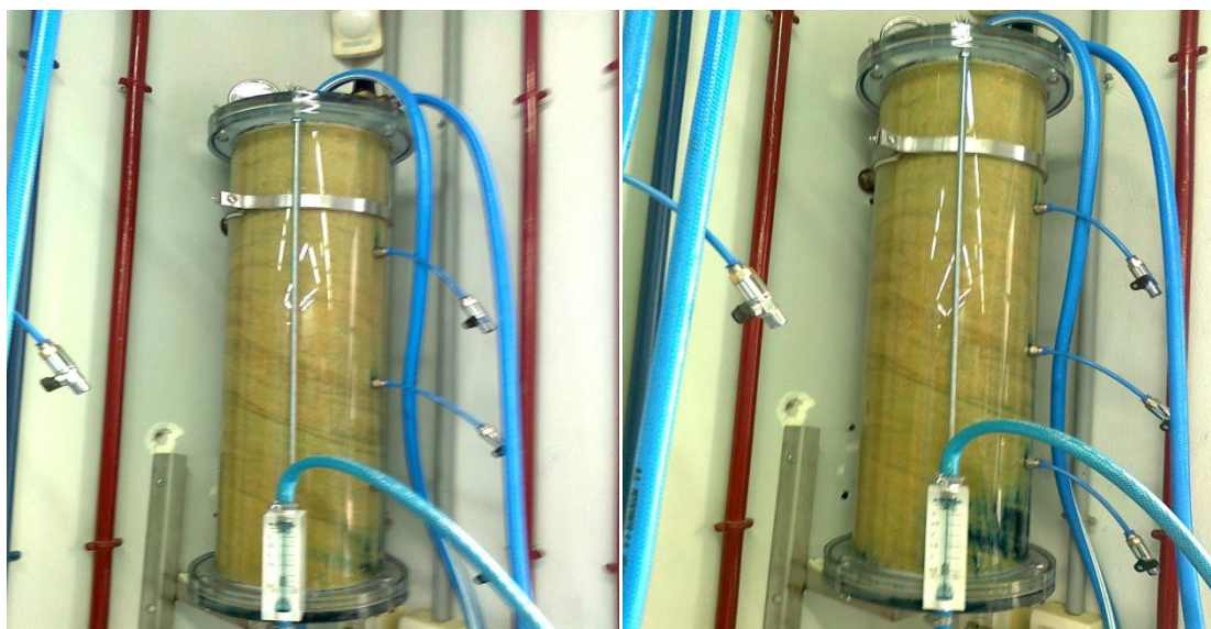
Εικόνα 11: Στήλη προσρόφησης (μήκους 75cm) κυανού του μεθυλενίου κατά την διαδικασία
