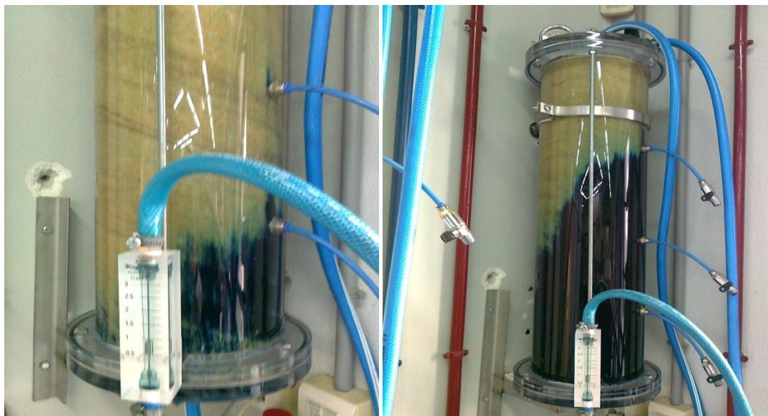
Εικόνα 13: Στήλη προσρόφησης (μήκους 75cm) κυανού του μεθυλενίου κατά την διαδικασία σε μερικό κορεσμό
