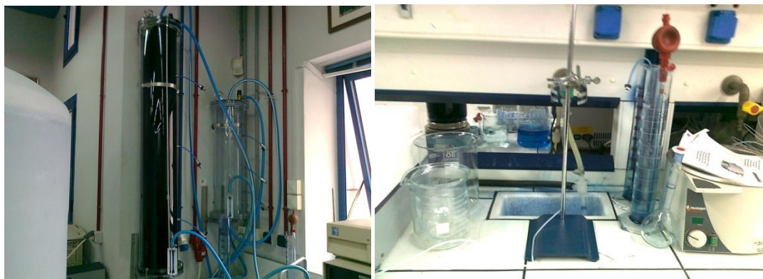
Εικόνα 57: Στήλη προσρόφησης (μήκους 150cm) κυανού του μεθυλενίου κατά την διαδικασία σε μερικό κορεσμό και αντλία κενού τύπου La Prep και σχετική συνδεσμολογία
