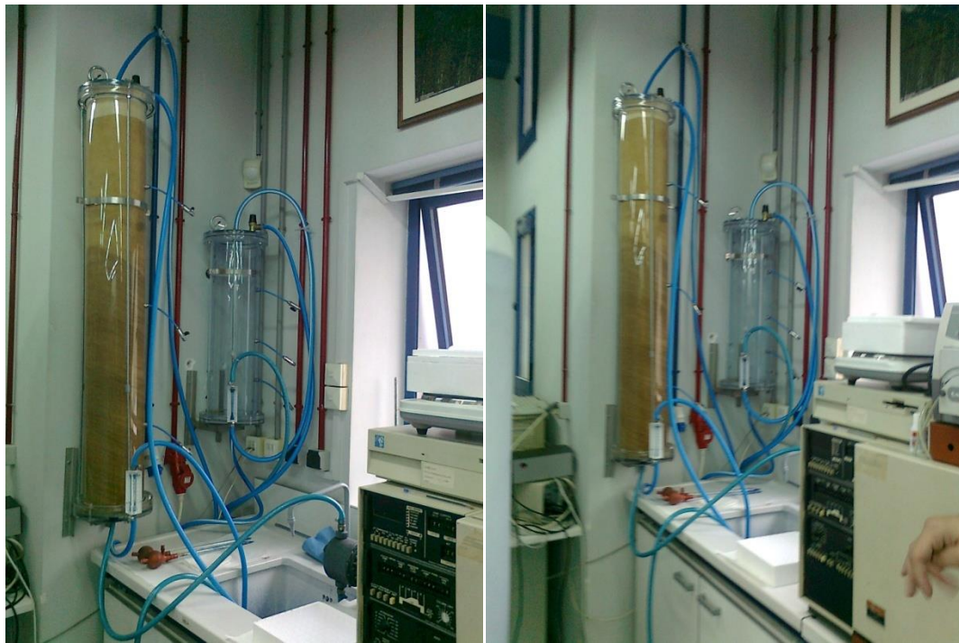
Εικόνα 28: Στήλη προσρόφησης (μήκους 150cm) κυανού του μεθυλενίου κατά την διαδικασία
