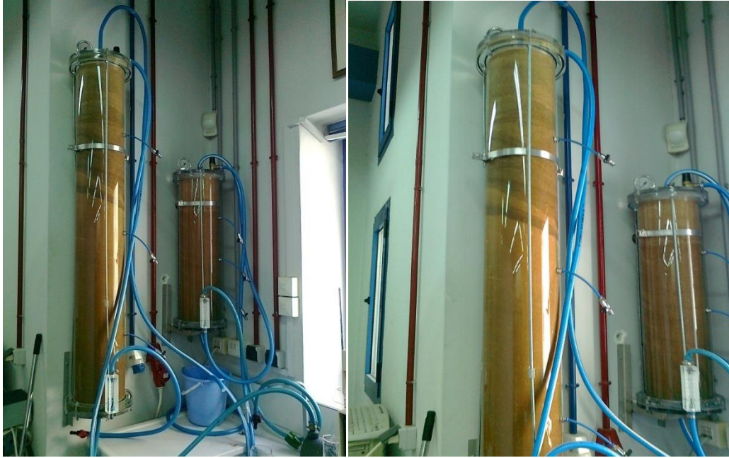
Εικόνα 120: Προσρόφηση εξασθενούς χρωμίου σε στήλες μήκους 75cm και 150cm αντίστοιχα
