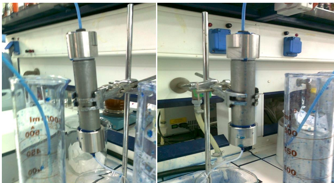
Εικόνα 54: Στήλη προσρόφησης (μήκους 15cm) κυανού του μεθυλενίου κατά την διαδικασία σε μερικό κορεσμό και διάλυμα κυανού του μεθυλενίου (Methylene Blue)
