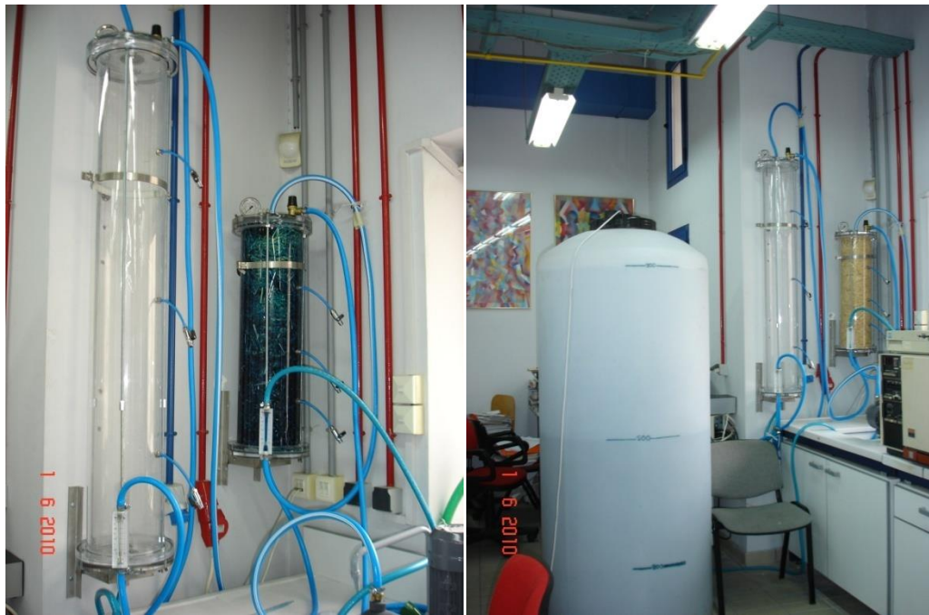
Εικόνα 110: Απροκατέργαστο άχυρο σιταριού σε στήλη μήκους 75cm αρχικά και τελικά του πειράματος.
