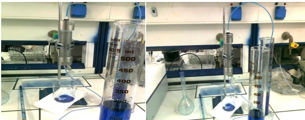
Εικόνα 53: Στήλη προσρόφησης (μήκους 15cm) κυανού του μεθυλενίου κατά την διαδικασία σε μερικό κορεσμό και διάλυμα κυανού του μεθυλενίου (Methylene Blue)
