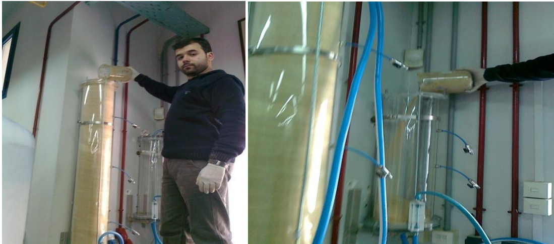
Εικόνα 3: Πλήρωση στήλης μήκους 75cm και 150cm με απροκατέργαστο πριονίδι ερυθρελάτης (spruce)
