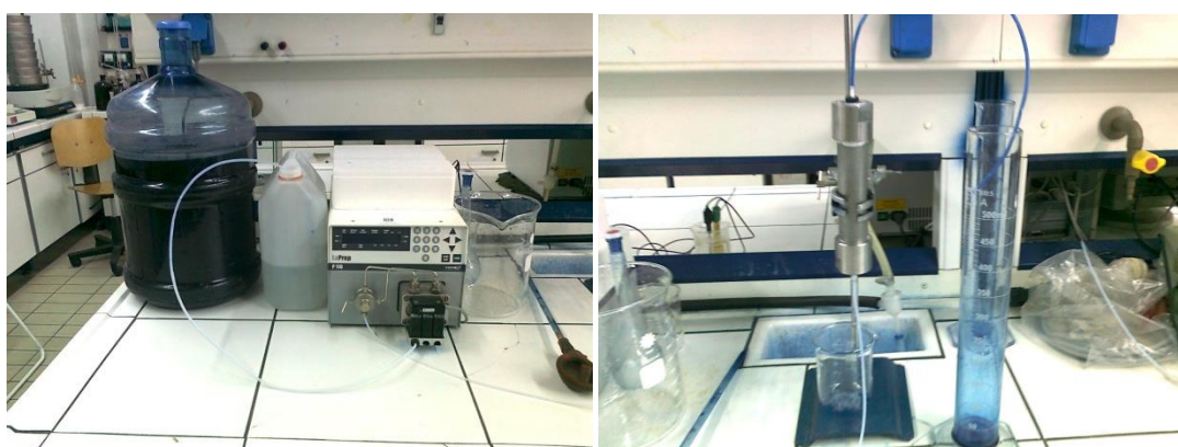
Εικόνα 51: Στήλη προσρόφησης (μήκους 15cm) κυανού του μεθυλενίου κατά την διαδικασία σε μερικό κορεσμό και διάλυμα κυανού του μεθυλενίου (Methylene Blue)
