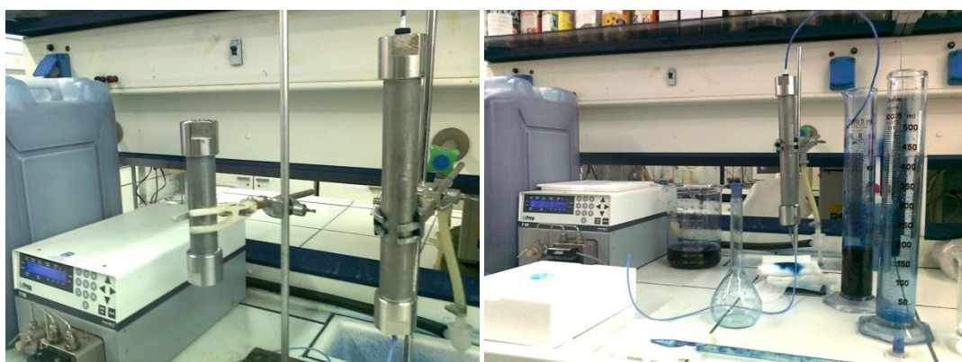
Εικόνα 97: Στήλες προσρόφησης μήκους 15cm και 25cm αντίστοιχα με πληρωτικό υλικό απροκατέργαστα ποσειδώνια (φύκια)
