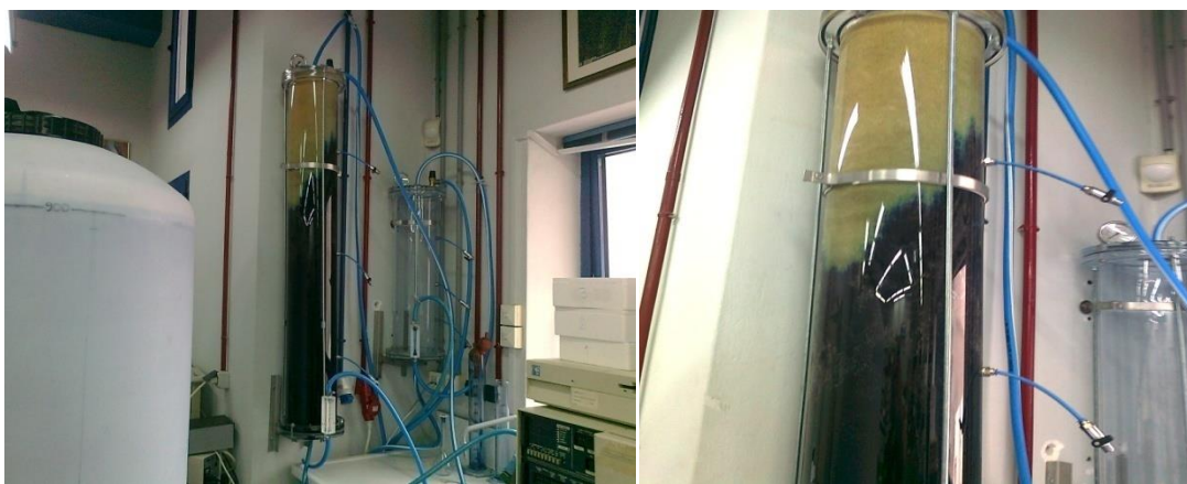
Εικόνα 38: Στήλη προσρόφησης (μήκους 150cm) κυανού του μεθυλενίου κατά την διαδικασία σε μερικό κορεσμό
