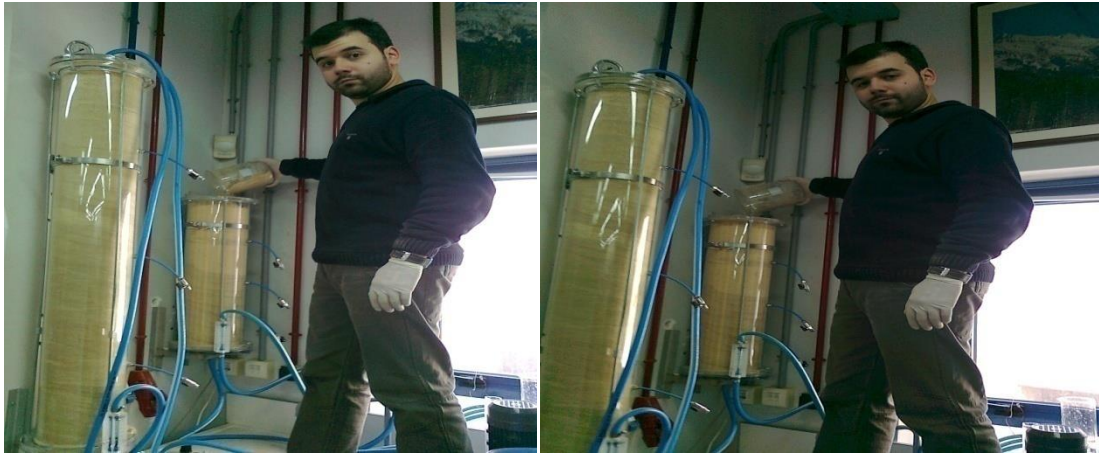
Εικόνα 5: Πλήρωση στήλης μήκους 75cm με αποκατέργαστο πριονίδι ερυθρελάτης (spruce)
