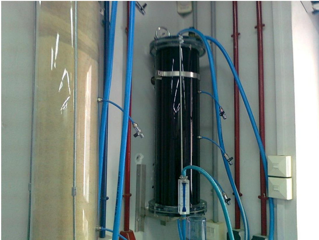
Σχήμα 7: Στήλη προσρόφησης πιλοτικής κλίμακας μήκους κλίνης 150cm (αριστερά) και μήκους κλίνης 75cm (δεξιά).
