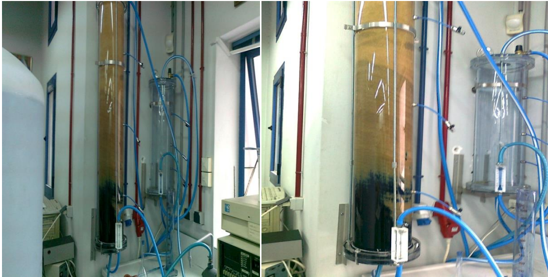
Εικόνα 36: Στήλη προσρόφησης (μήκους 150cm) κυανού του μεθυλενίου κατά την διαδικασία σε μερικό κορεσμό
