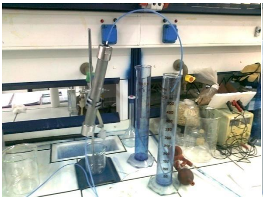
Εικόνα 94: Στήλες προσρόφησης μήκους 15cm και 25cm αντίστοιχα με πληρωτικό υλικό απροκατέργαστα ποσειδώνια (φύκια)
