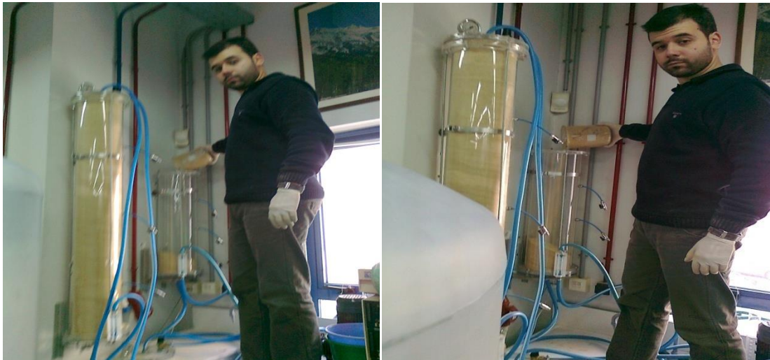
Εικόνα 4: Πλήρωση στήλης μήκους 75cm με απροκατέργαστο πριονίδι ερυθρελάτης (spruce)
