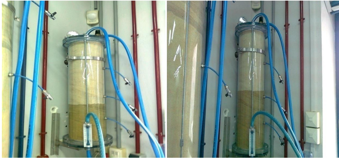
Εικόνα 10: Στήλη προσρόφησης (μήκους 75cm) κυανού του μεθυλενίου κατά την διαδικασία
