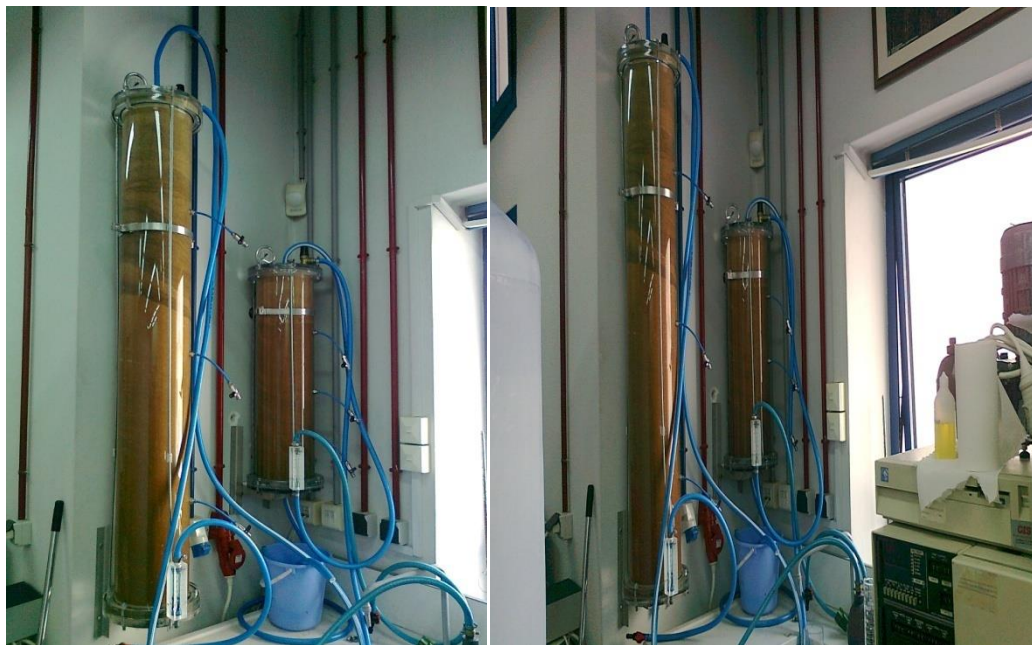
Εικόνα 119: Προσρόφηση εξασθενούς χρωμίου σε στήλες μήκους 75cm και 150cm αντίστοιχα
