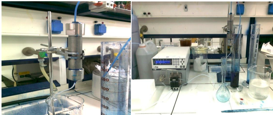
Εικόνα 56: Στήλη προσρόφησης (μήκους 15cm) κυανού του μεθυλενίου κατά την διαδικασία σε μερικό κορεσμό και διάλυμα κυανού του μεθυλενίου (Methylene Blue) και αντλία κενού τύπου La Prep
