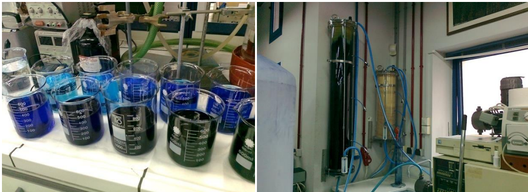
Εικόνα 9: Διαλύματα κυανού του μεθυλενίου (Methylene Blue), χρωστικής που χρησιμοποιείται στην κλωστοϋφαντουργία, σε διαφορετικές τιμές συγκέντρωσης και στήλες προσρόφησης
