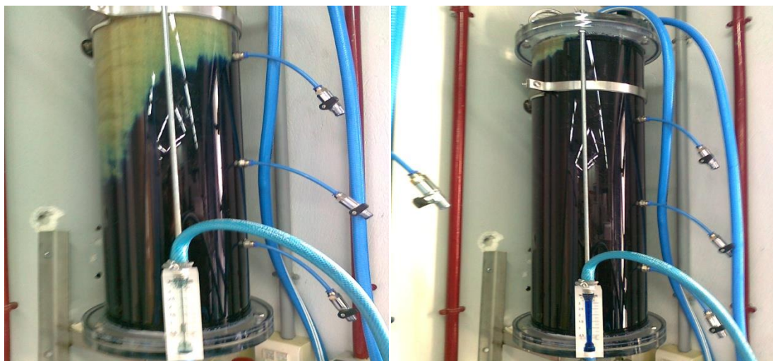
Εικόνα 14: Στήλη προσρόφησης (μήκους 75cm) κυανού του μεθυλενίου κατά την διαδικασία σε μερικό κορεσμό
