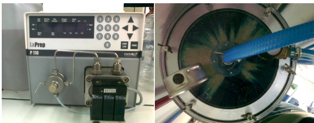
Εικόνα 60: Αντλία κενού τύπου La Prep και κεφαλή στήλης διαμέτρου 25cm
