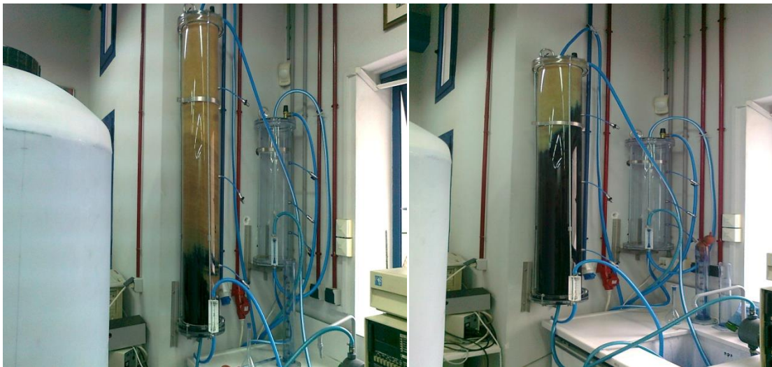
Εικόνα 37: Στήλη προσρόφησης (μήκους 150cm) κυανού του μεθυλενίου κατά την διαδικασία σε μερικό κορεσμό
