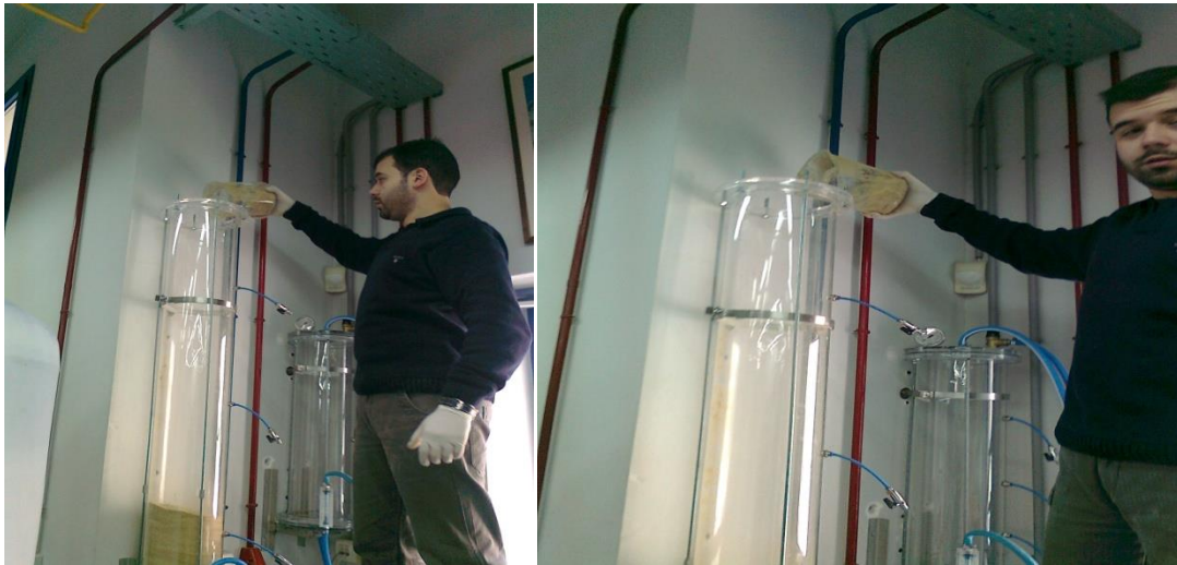
Εικόνα 1: Πλήρωση στήλης μήκους 150cm με απροκατέργαστο πριονίδι ερυθρελάτης (spruce)
