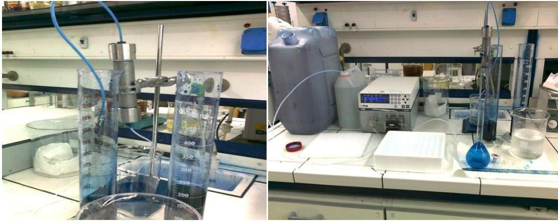
Εικόνα 52: Στήλη προσρόφησης (μήκους 15cm) κυανού του μεθυλενίου κατά την διαδικασία σε μερικό κορεσμό και διάλυμα κυανού του μεθυλενίου (Methylene Blue)
