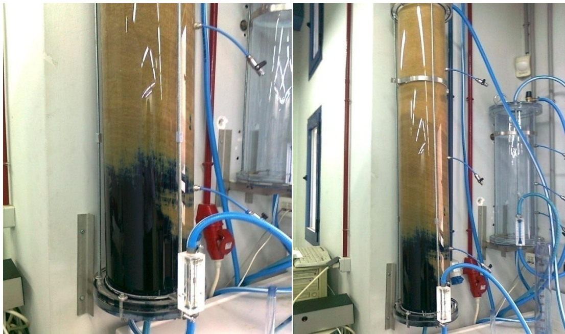
Εικόνα 34: Στήλη προσρόφησης (μήκους 150cm) κυανού του μεθυλενίου κατά την διαδικασία σε μερικό κορεσμό
