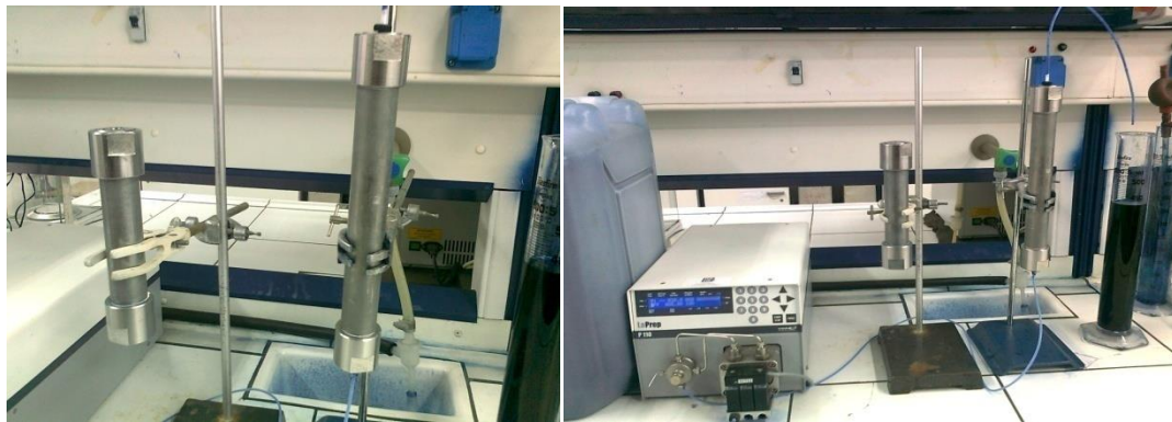
Εικόνα 96: Στήλες προσρόφησης μήκους 15cm και 25cm αντίστοιχα με πληρωτικό υλικό απροκατέργαστα ποσειδώνια (φύκια)
