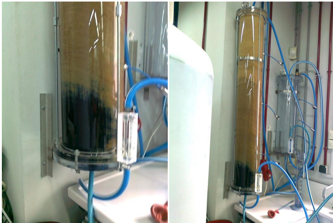
Εικόνα 32: Στήλη προσρόφησης (μήκους 150cm) κυανού του μεθυλενίου κατά την διαδικασία σε μερικό κορεσμό
