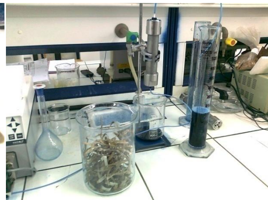
Εικόνα 93: Στήλη προσρόφησης μήκους 15cm με πληρωτικό υλικό απροκατέργαστα ποσειδώνια (φύκια)
