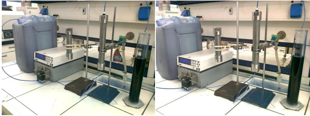
Εικόνα 95: Στήλες προσρόφησης μήκους 15cm και 25cm αντίστοιχα με πληρωτικό υλικό απροκατέργαστα ποσειδώνια (φύκια)
