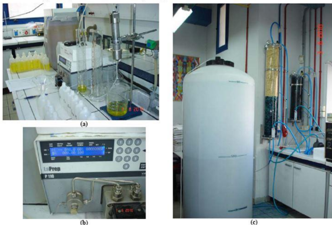
Σχήμα 57: (α) Εργαστηριακής κλίμακας στήλη ύψους 15 εκατοστών με δεξαμενή 25 L, (β) τη αντλία εργαστηριακής κλίμακας, και (γ) πιλοτικής κλίμακας στήλη ύψους 137 εκατοστών με δεξαμενή 1000 L.
