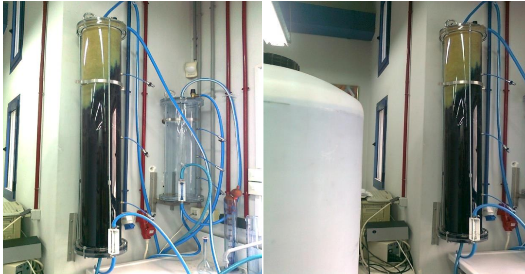
Εικόνα 40: Στήλη προσρόφησης (μήκους 150cm) κυανού του μεθυλενίου κατά την διαδικασία σε μερικό κορεσμό
