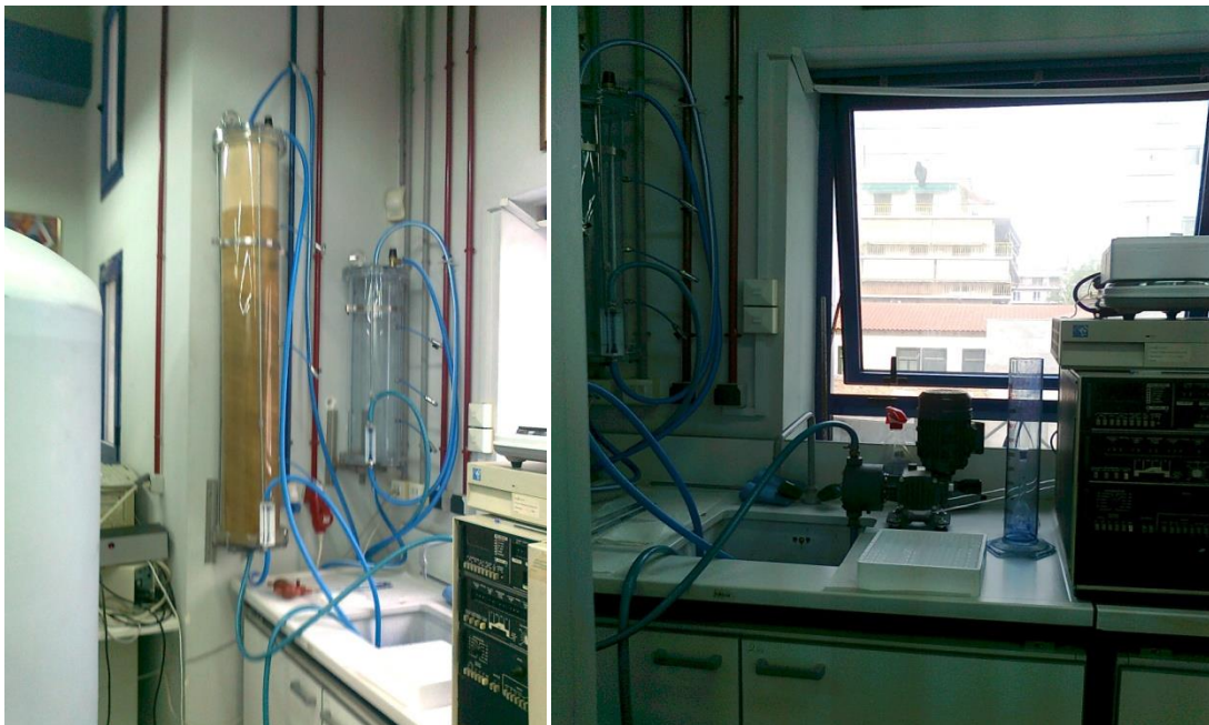
Εικόνα 25: Στήλη προσρόφησης (μήκους 150cm) κυανού του μεθυλενίου και αντλία κενού κατά την διαδικασία
