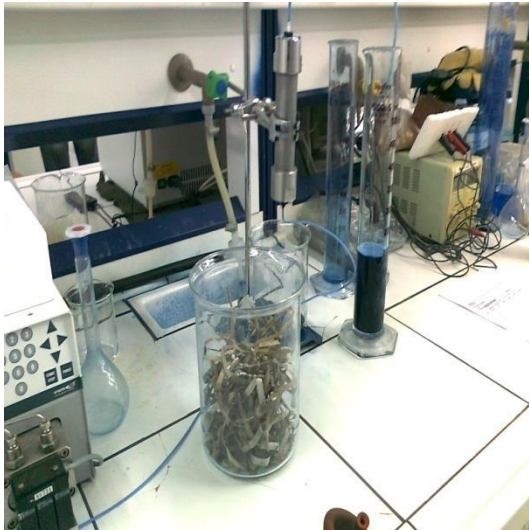
Εικόνα 92: Στήλη προσρόφησης μήκους 15cm με πληρωτικό υλικό απροκατέργαστα ποσειδώνια (φύκια)
