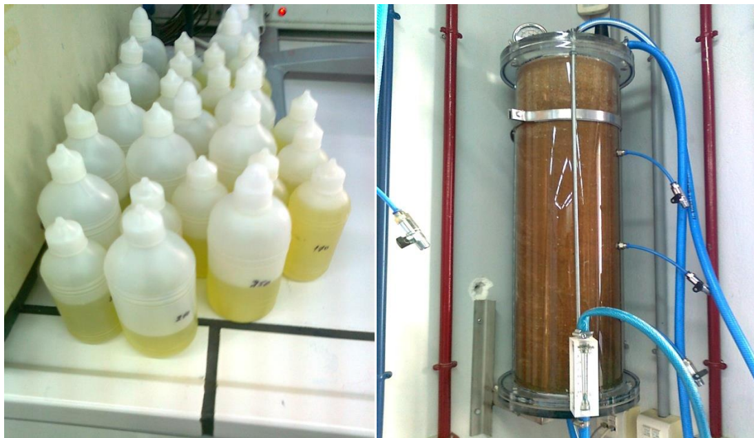
Εικόνα 117: Δείγματα εξασθενούς χρωμίου σε διαφορετική συγκέντρωση ως προσροφούμενη ουσία σε στήλη προσρόφησης μήκους 75cm
