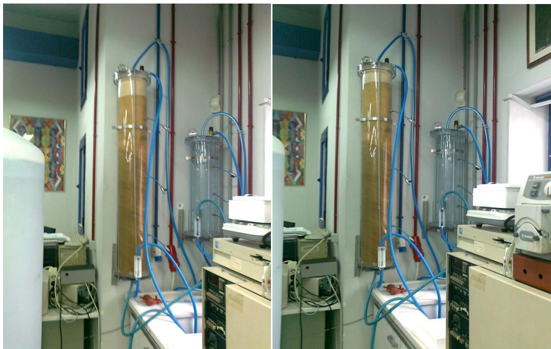
Εικόνα 27: Στήλη προσρόφησης (μήκους 150cm) κυανού του μεθυλενίου κατά την διαδικασία
