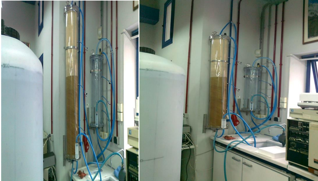
Εικόνα 20: Στήλη προσρόφησης (μήκους 150cm) κυανού του μεθυλενίου κατά την διαδικασία
