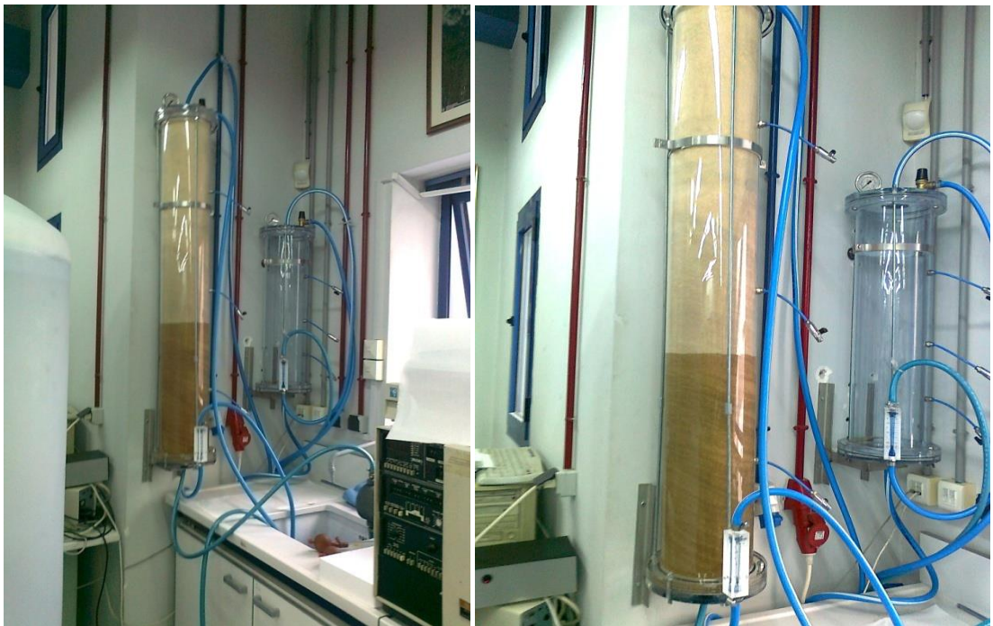
Εικόνα 21: Στήλη προσρόφησης (μήκους 150cm) κυανού του μεθυλενίου κατά την διαδικασία
