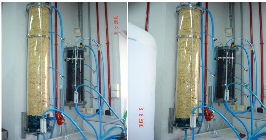
Εικόνα 111: Απροκατέργαστο άχυρο σιταριού σε ολικώς κορεσμένη στήλη μήκους 75cm και μερικώς κορεσμένη στήλη μήκους 150cm
