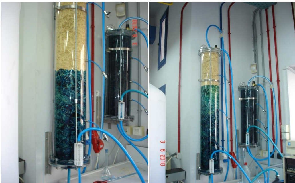
Εικόνα 113: Απροκατέργαστο άχυρο σιταριού σε ολικώς κορεσμένη στήλη μήκους 75cm και μερικώς κορεσμένη στήλη μήκους 150cm
