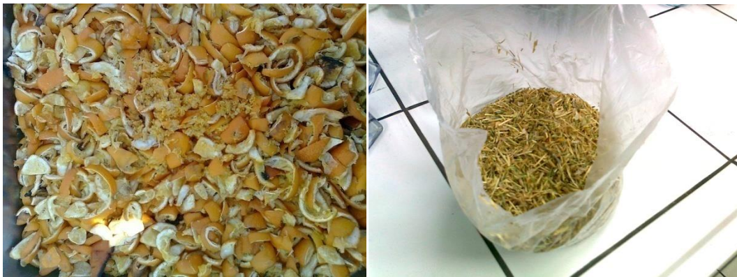
Εικόνα 102: Φλούδες πορτοκαλιού σε φυσική ξήρανση και απροκατέργαστο άχυρο φακής για χρήση ως προσροφητικό υλικό
