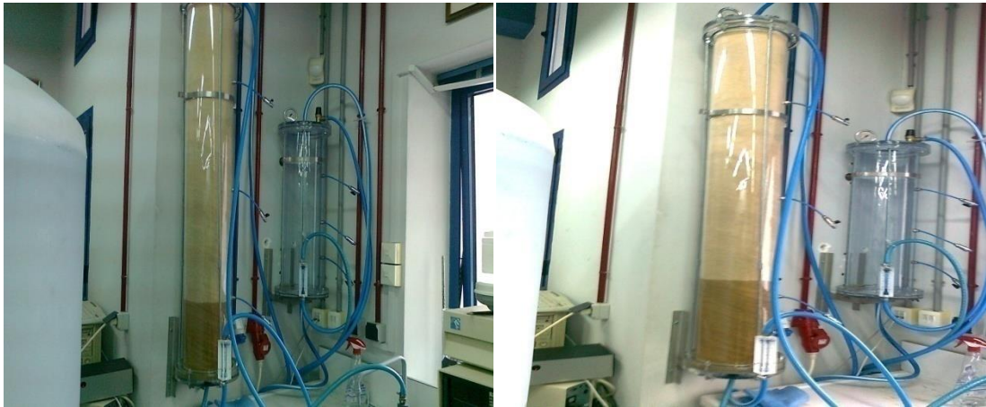
Εικόνα 18: Στήλη προσρόφησης (μήκους 150cm) κυανού του μεθυλενίου κατά την διαδικασία
