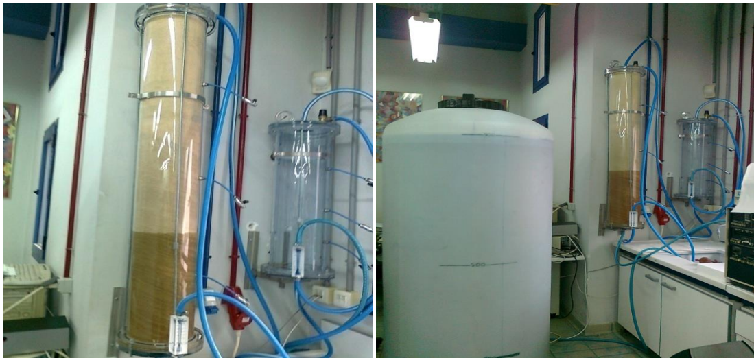
Εικόνα 19: Στήλη προσρόφησης (μήκους 150cm) κυανού του μεθυλενίου κατά την διαδικασία
