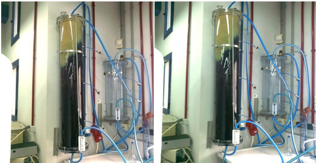
Εικόνα 43: Στήλη προσρόφησης (μήκους 150cm) κวานού του μεθυλενίου κατά την διαδικασία σε μερικό κορεσμό
