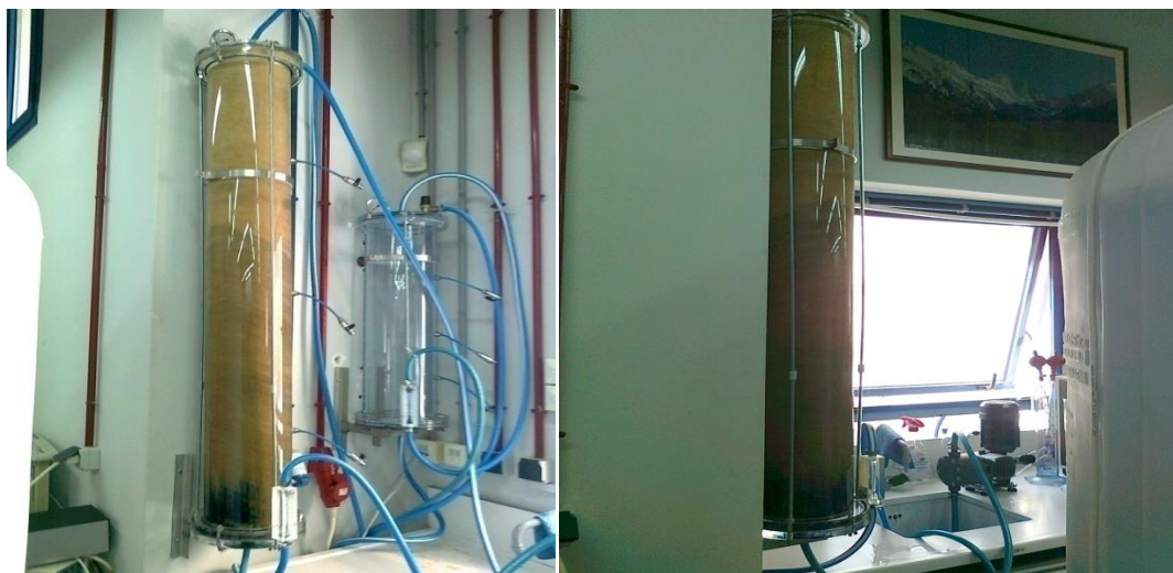
Εικόνα 29: Στήλη προσρόφησης (μήκους 150cm) κυανού του μεθυλενίου κατά την διαδικασία σε μερικό κορεσμό
