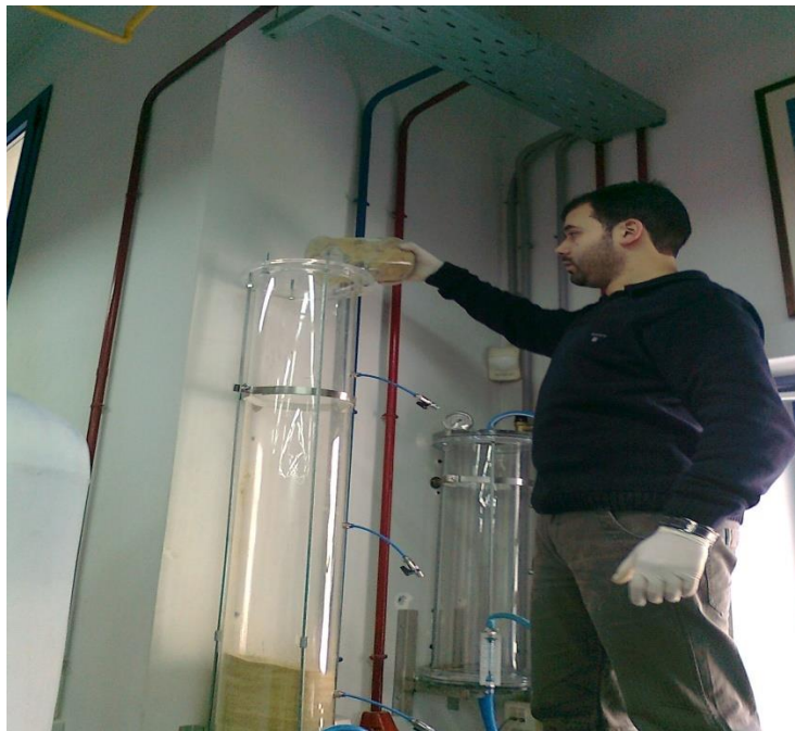
Σχήμα 16: Πλήρωση στηλών μήκους κλίνης 75cm και 150cm αντίστοιχα με αποκατέργιστο πριονίδι ερυθρελάτης.
