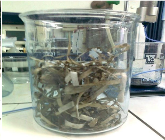
Εικόνα 92: Στήλη προσρόφησης μήκους 15cm με πληρωτικό υλικό απροκατέργαστα ποσειδώνια (φύκια)
