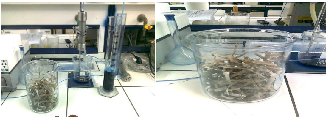
Εικόνα 91: Στήλη προσρόφησης μήκους 15cm με πληρωτικό υλικό απροκατέργαστα ποσειδώνια (φύκια)
