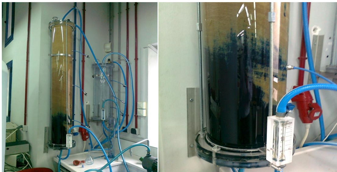
Εικόνα 35: Στήλη προσρόφησης (μήκους 150cm) κυανού του μεθυλενίου κατά την διαδικασία σε μερικό κορεσμό
