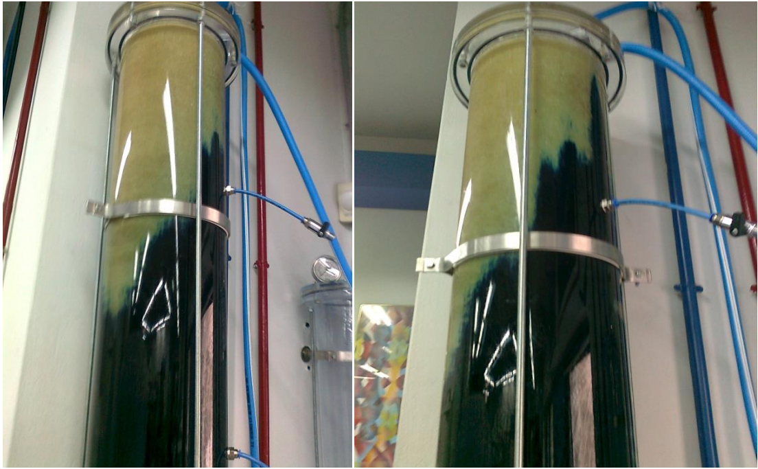
Εικόνα 44: Στήλη προσρόφησης (μήκους 150cm) κυανού του μεθυλενίου κατά την διαδικασία σε μερικό κορεσμό
