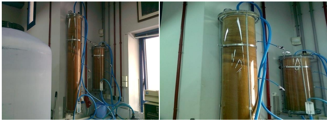
Εικόνα 118: Προσρόφηση εξασθενούς χρωμίου σε στήλες μήκους 75cm και 150cm αντίστοιχα
