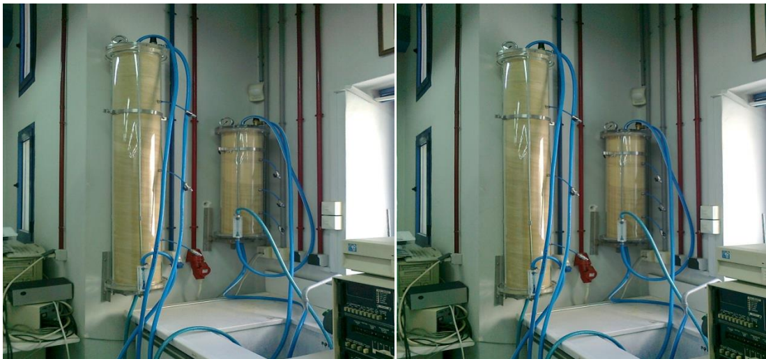
Εικόνα 6: Στήλες μήκους 75cm και 150cm αντίστοιχα με πληρωτικό υλικό αποκατέργαστο πριονίδι ερυθρελάτης (spruce)
