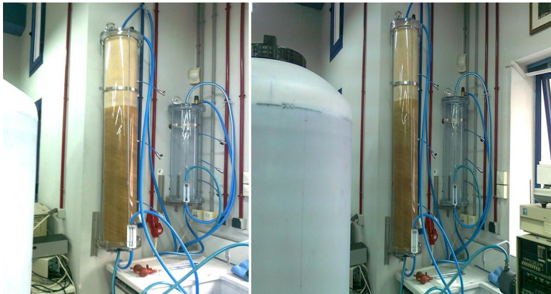
Εικόνα 22: Στήλη προσρόφησης (μήκους 150cm) κυανού του μεθυλενίου κατά την διαδικασία
