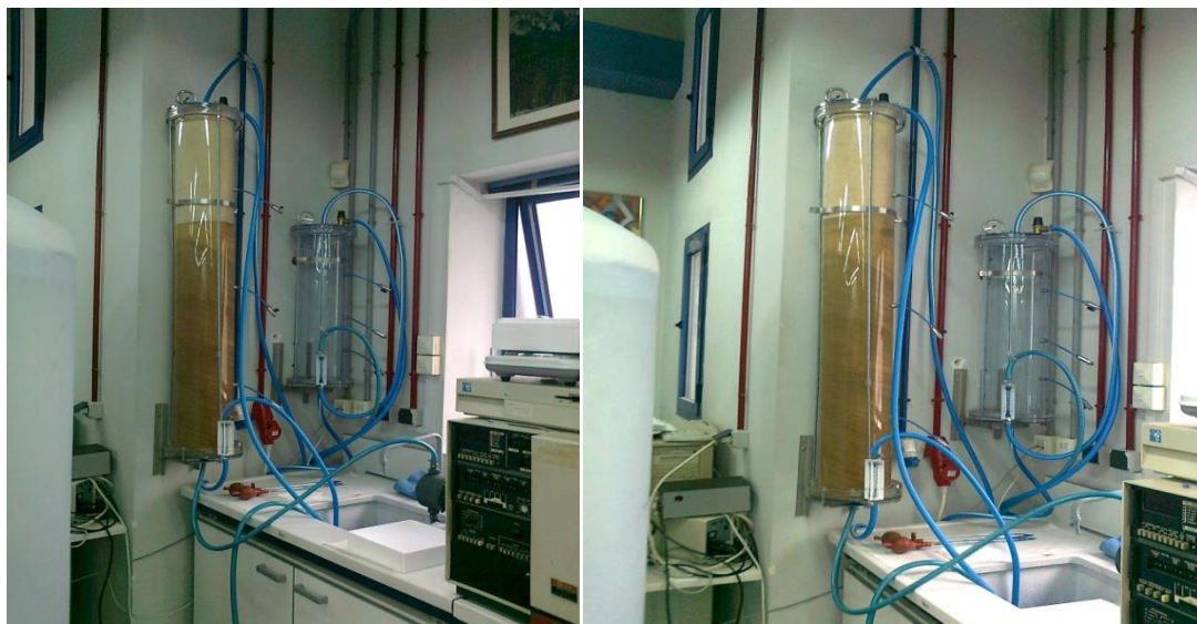
Εικόνα 23: Στήλη προσρόφησης (μήκους 150cm) κυανού του μεθυλενίου κατά την διαδικασία
