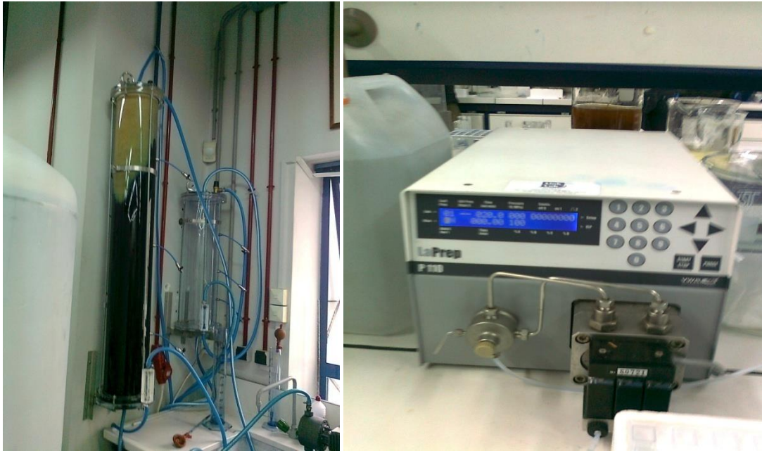
Εικόνα 46: Στήλη προσρόφησης (μήκους 150cm) κυανού του μεθυλενίου κατά την διαδικασία σε μερικό κορεσμό και αντλία κενού τύπου La Prep
