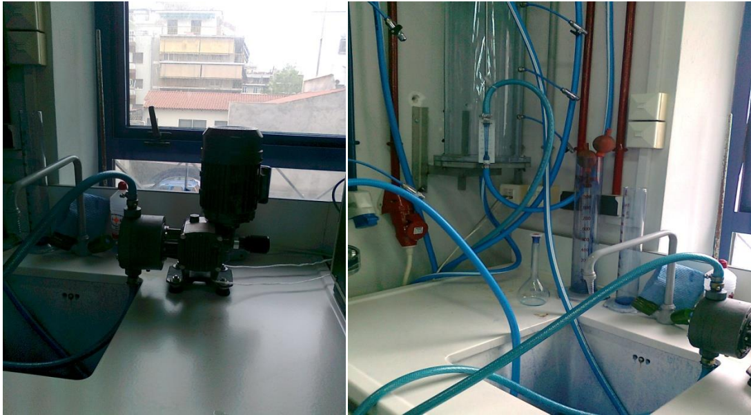
Εικόνα 42: Αντλία κενού και συνδεσμολογία στηλών προσρόφησης μήκους 75cm και 150cm αντίστοιχα
