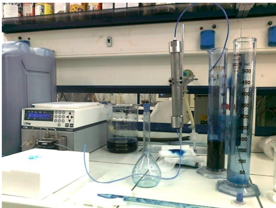
Σχήμα 29: Χαλύβδινη στήλη προσρόφησης μήκους κλίνης 25cm, ογκομετρικός κύλινδρος και αντλία κενού.
