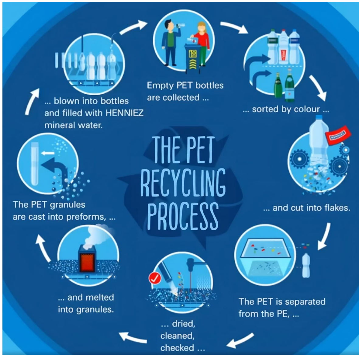
Εικόνα 1 Βήματα διεργασίας ανακύκλωσης φιάλων PET
