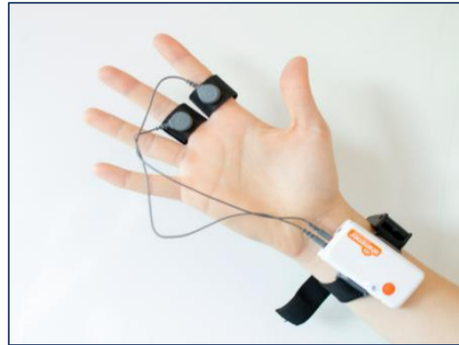
Εικόνα 3.3.3: Μέτρηση στις ηλεκτρικής αγωγιμότητας του δέρματος, (Πηγή: imotions.gr,2019 )
